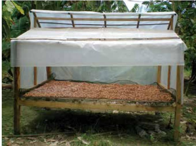
**Gambar 2.** Alat Pengereng dengan Penutup Plastik
